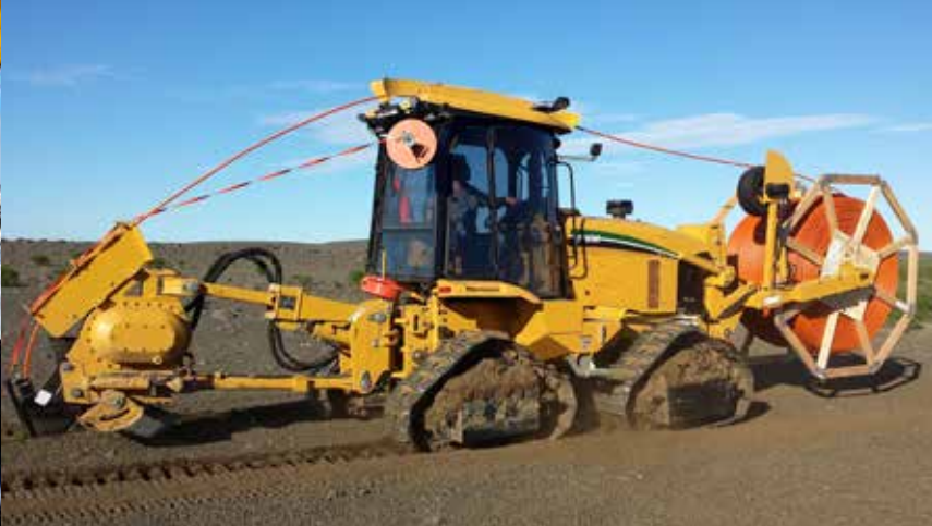
Sérsmíðuð plægingarvél í eigu Tengis, sú eina sinnar tegundar á landinu. Þessi er mikið notuð og hefur plægt niður stóran hluta ljósleiðaranetsins á Norðausturlandi.
