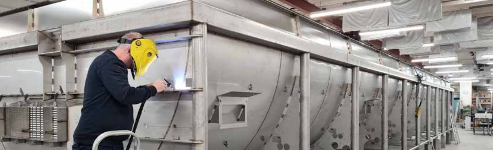
Frá smíðavinnu í smíðju Skaginn3X á Ísafirði, verið að smíða kælisingiltank fyrir laxeldi í Noregi. / Ljós. Árni Helgason.
