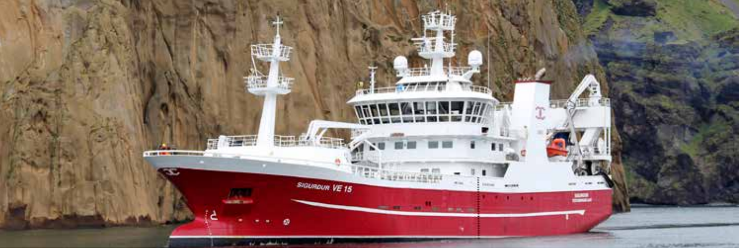
Sigurður er uppsjávarskip sem var smíðað hjá Celiktrans í Tyrklandi og afhent árið 2014. Skipið er 80,3m langt, 17m breitt og 3.763BT.
