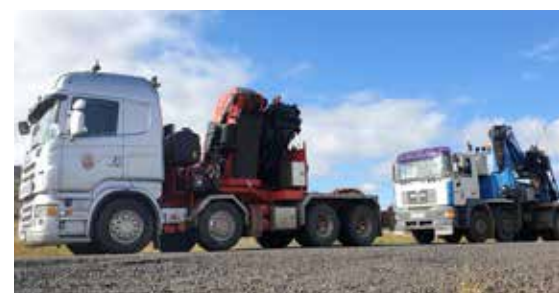
Tvær kranabifreiðar frá ÞPP, sú hægra megin er 150 tonn metrar og hin 90 tonn metrar, griðarlega öflugir kranar báðir.
