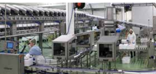
Hátæknibúnaður sem samanstendur af fiskinnmötun og gæðaskoðun, sjálfvirkum heilfiskflokkara og kassakerfi.
