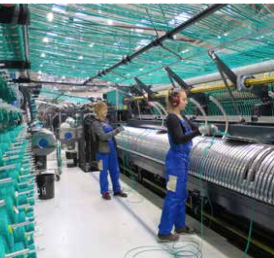
Hnýting á polyethyleneti fyrir botntröll í Hampidjan Baltic.
