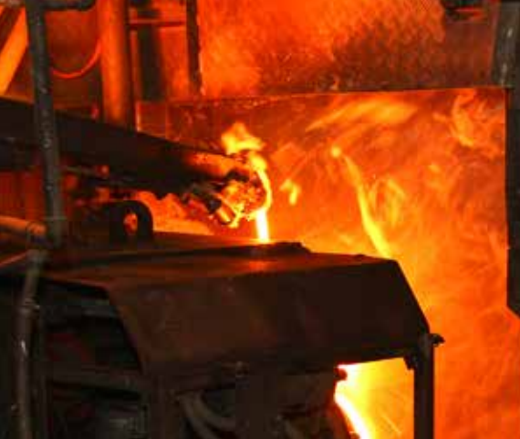
Bráð úr rafbræðsluofni rennt á spunahjól, sem myndar þræði steinullarmottunnar.
