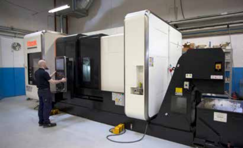
Mazak Integrex Multitasking rennir viðfangsefni sín út frá 10 ása hreyfingu þar sem möguleikarnir eru nánast óteljandi.
