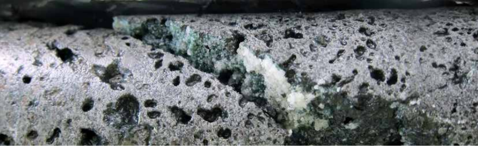
Borkjarni af basalti með steinrunnu koldíoxíði í formi kalsíts. Ljós. Carbfix / Sandra O. Snæbjörnsdóttir.
