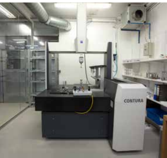
Gæðasalur Vélvíkur. Þar er ZEISS Contura mælivél í aðalhlutverki en hún gerir nákvæmstu gæðamælingar mögulegar.
