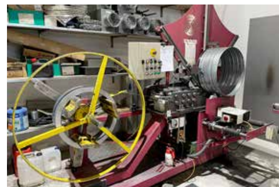
Smíðum rör í loftræstingar og steypuhólka.
