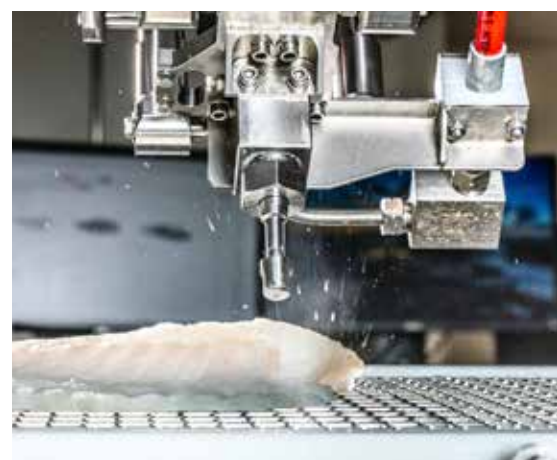
Vatnskurðarvélina hefur verið grunnur að örum vexti Völku á síðustu árum.
