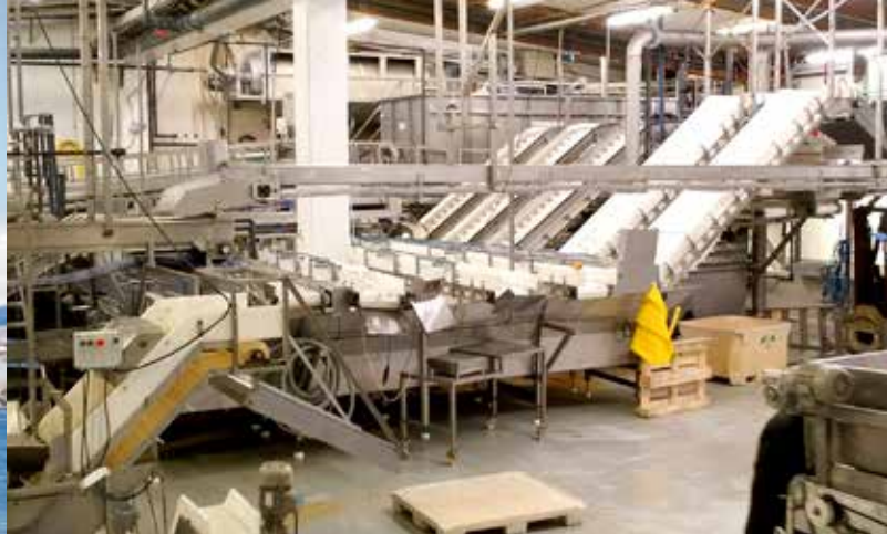
Ryðfrítt Stáltech færband, smíðað fyrir Ísfélag Vestmannaeyja á Þórshöfn.
