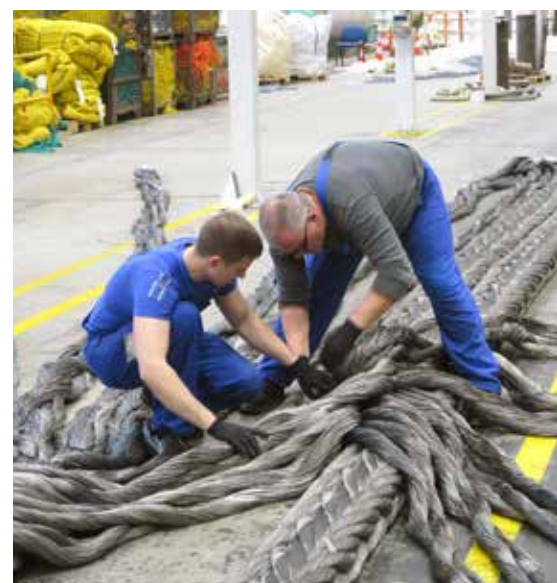
Splæsing á 200 mm sveru ofurtógi fyrir olíuönduðinn.
