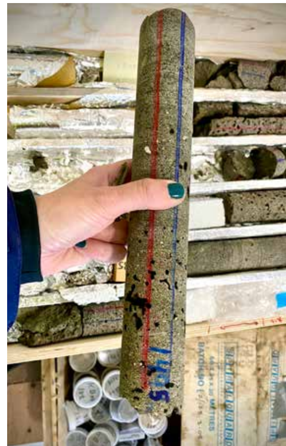
Basaltkjarni frá tilraunaniðurdælingarsvæði Carbfix á Hellisheiði sem inniheldur steinrunnið koldíoxíð í formi kalsítsteinda. / Ljós. Sandra Ósk Snæbjörnsdóttir.
