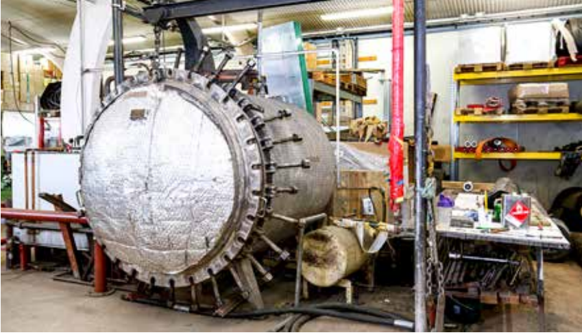
Gufuketillinn sem notaður er til að sjóða gúmmí á ýmsa hluti, s.s. álkefli og hjól.
