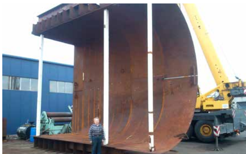
Á myndinni er Sigurður Jónsson stofnandi Vélsmiðju Sigurðar Jónssonar. Myndin sýnir helming breytistykkis annarrar af tveimur fallpípum sem fóru í Búðarhálsvirkjun og sýnir vel hversu stór þau voru.
