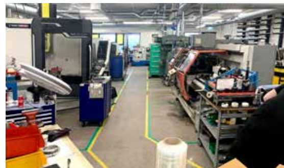
Renni- og vélaverkstæði KAPP smíða íhluti í alls konar tæki úr málmum eða plasti ásamt því að taka upp vélar og hedd, vinna við blokkir, sveifarása, gira, öxla og pottsjóða ásamt málmfyllingu og slípun.
