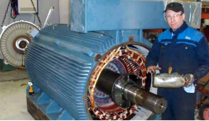
Mótorvindingar og leguskipti á flestum stærðum og gerðum rafmótora og rafala.
