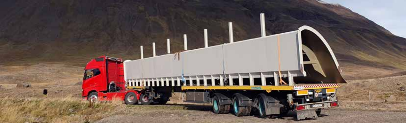
Flutningur á hækkun á yfirfalli vegna Djúpadalsvirkjunar.
