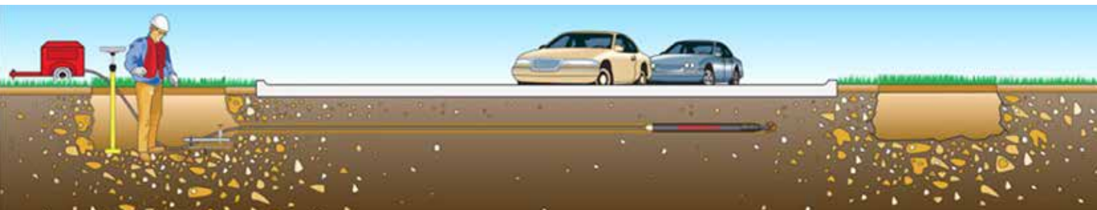
Sníld að ekki þarf að stöðva umferð meðan unnið er.
