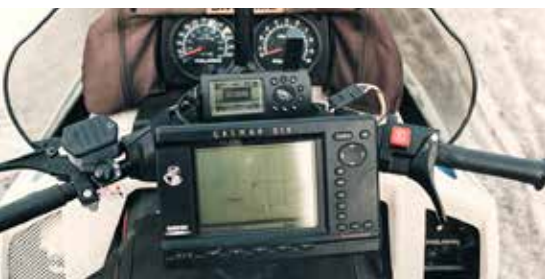
Í þá gömlu daga, snjósleði árið 1999 í eigu Benedikts Bragasonar. Þarna eru þrjú Garmin tæki, tvö með skjá og svarta loftnetið sem er leiðréttingartæki sem jók nákvæmni umtalsvert á þessum tíma þegar GPS kerfið var „ruglað“, gert ónákvæmara vegna varnamála Bandaríkjamanna.
