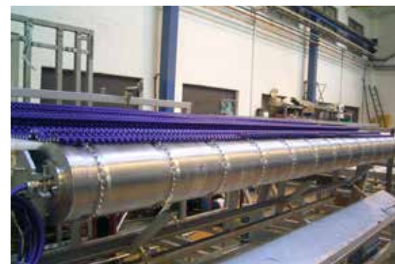
Sérsmíðaður trommlumótur fyrir innmötun u.þ.b. 3 m langur.
